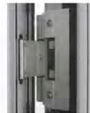
3-PART BARREL HINGE Optional for all aluminium door series - Patentiertes Dübelssystem für die Befestigung bei nach außen öffnenden Türen ermöglicht hohen Lastabtrag - Bewährte Befestigungstechnik bei nach innen öffnenden Türen - 3-dimensionale Einstellung möglich - Einbruchhemmend bis WK3 (RC3) - Max. Flügelgewicht 200 kg
