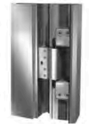
VERDECKT LIEGENDE TÜRBÄNDER - Hoher Sicherheitsstandard durch komplett verdeckt liegenden Baschlag - Öffnungswinkel 100° - 100% Wartungsfrei - 2-dimensionale Einstellung möglich - Max. Flügelgewicht 120 kg - bei Standardmaßen der Tür werden zwei verdeckt liegende Türbänder verbaut.
